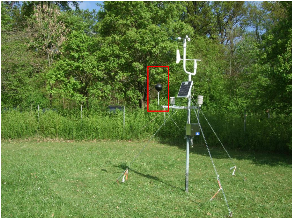
Abbildung 13: Messstation T3 2014 am Dornhaldenfriedhof im offenen Gelände außerhalb des Stadtkerns. Rot umrandet ist das installierte Globe Thermometer (DWD).
